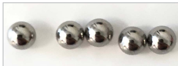
Рис. 1. Стальные шарики диаметром 4 мм
