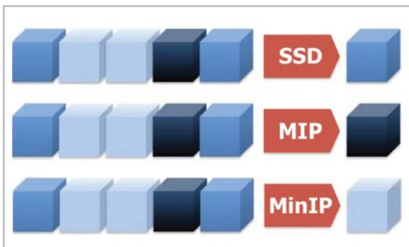
Рис. 4. Схематическое объяснение методов построения 3D-реконструкций.
