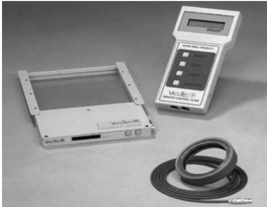
Рис. 8. Ионизационная (прозрачная) камера фирмы ВАКУТЕК.
